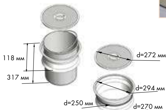
Схема и размеры модели с ведром:
