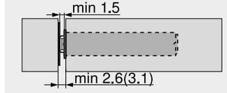
( ) Фиксирующая пластина на саморезы
