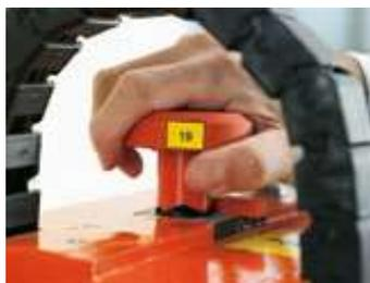
С помощью рукоятки револьверного типа легко устанавливаются разные фиксированные размеры глубины сверления
