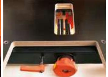
На станке настроены фиксированные расстояния от края до отверстий под петли, ответные планки, серийные отверстия и деревянные шканты. Также можно настроить и другие регулярно используемые размеры
