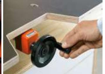
Расстояние до отверстия устанавливается с помощью шпинделя
