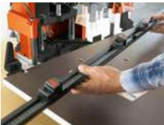
Линейка с предустановленными упорами, обозначенными определенными цветами, легко устанавливается без инструмента
