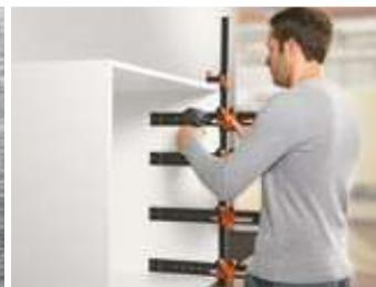
Универсальный штанговый кондуктор позволяет точно нанести разметку, например, для позиций крепления направляющих
