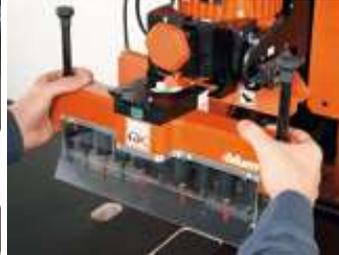
Сверлильная головка (обозначенная цветом) устанавливается и крепится с помощью зажимного рычага без инструмента
