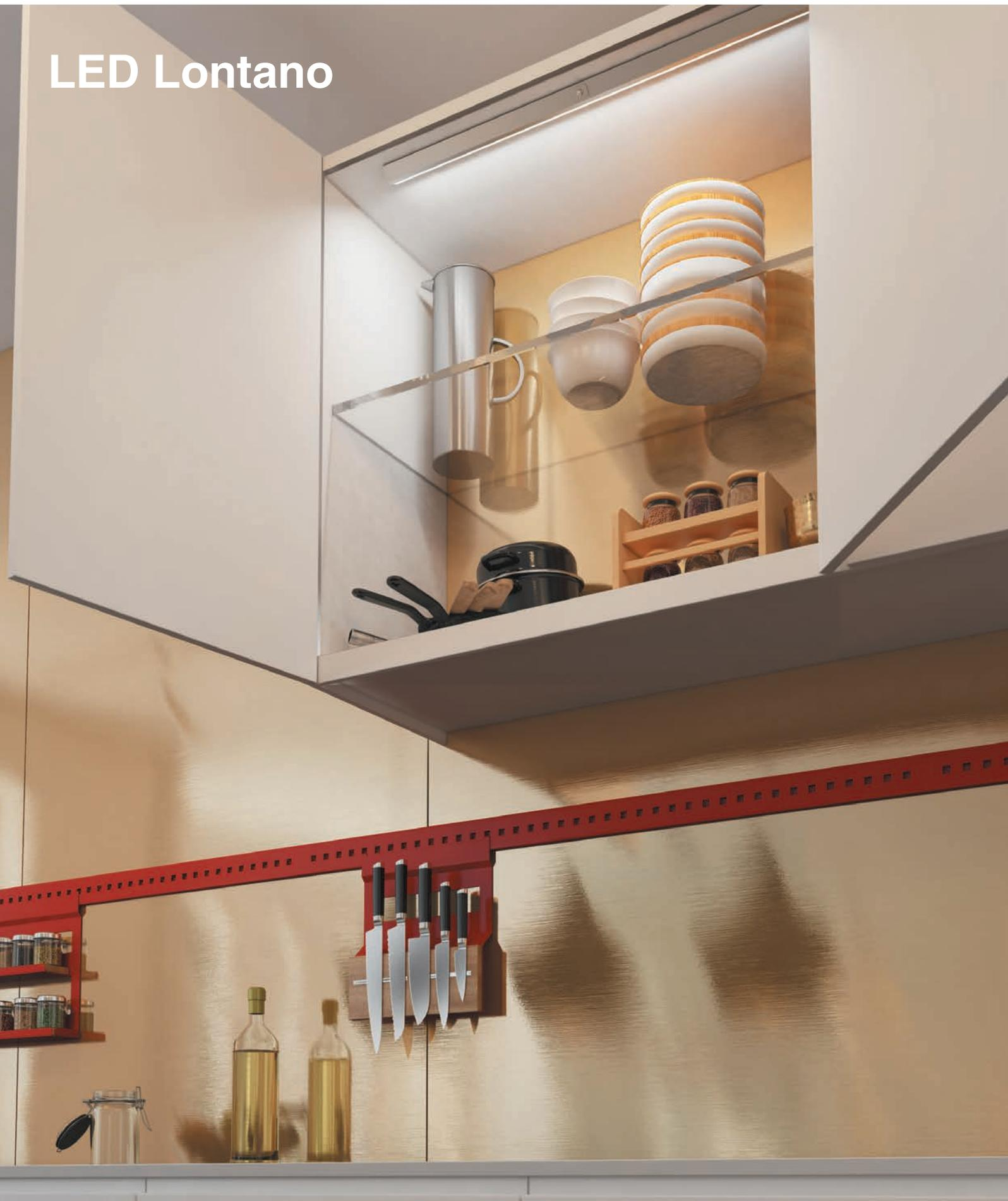
Накладной светильник предназначен для освещения внутреннего пространства мебели. В корпус светильника встроен PIR-датчик движения для автоматического управления светом. В зоне действия датчика свет включается при обнаружении движения и отключается — при его отсутствии. Зона действия датчика: 2000 мм. Время работы после последнего обнаружения движения — 30 секунд. Представлен в трех длинах: 400, 550 и 850 мм.
