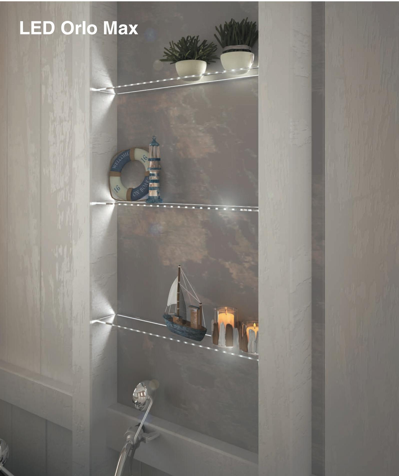
Светильник предназначен для торцевой подсветки полок. Устанавливается на стеклянные полки толщиной 8 мм. Представлен в 3 размерах: для корпусов шириной 450, 600 и 900 мм, изготовленных из 16 или 18 мм ДСП. Крепится при помощи двухстороннего скотча, установленного на задней стенке профиля светильника.
