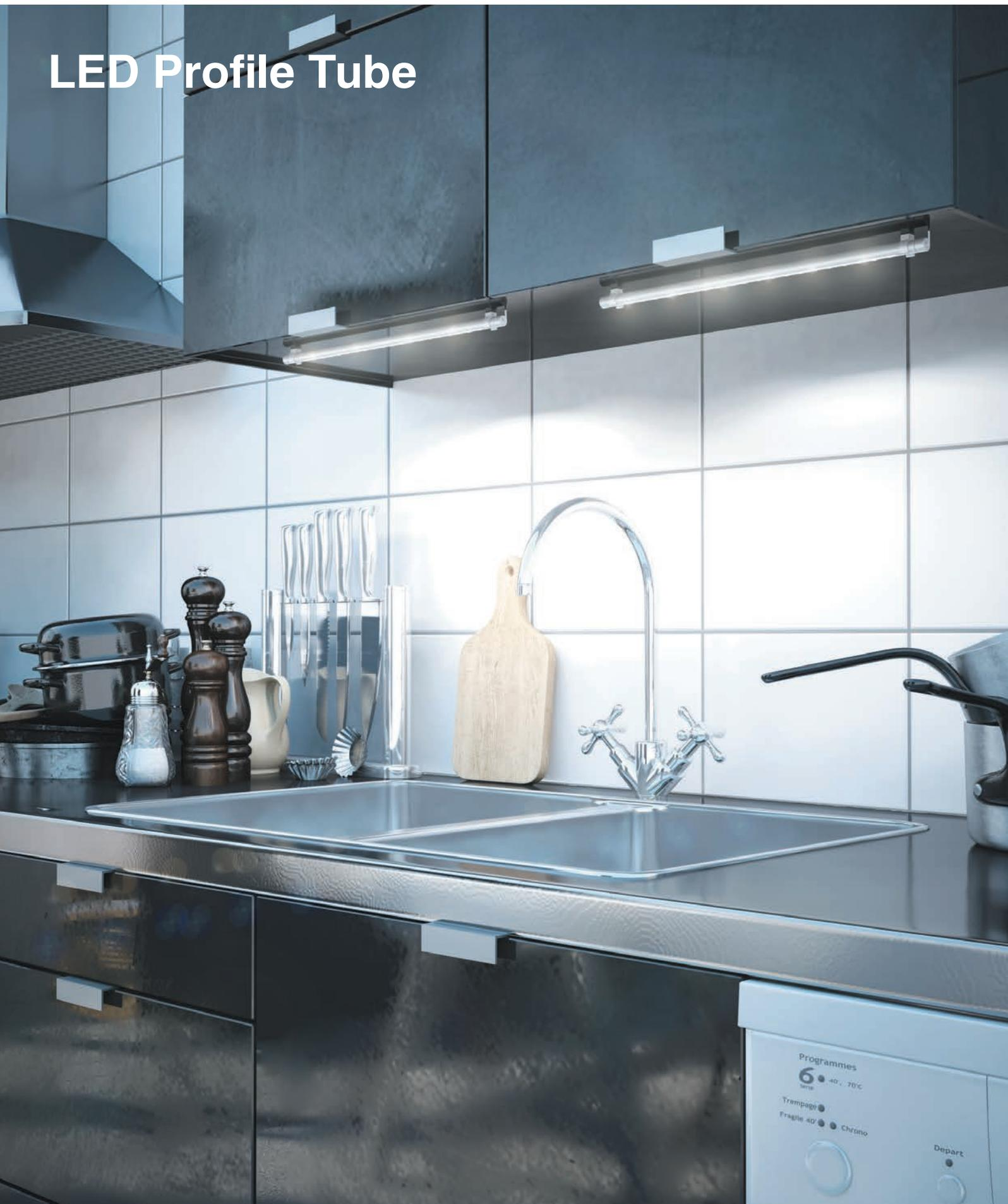
Светильники предназначены для освещения рабочих поверхностей и внутреннего пространства мебели. Изготовлены из алюминиевого профиля круглого сечения. Крепятся при помощи клипс, что позволяет направлять свет на нужную зону. Светильники имеют длину 350 мм и могут соединяться между собой в непрерывные цепи. Максимальное возможное количество светильников в цепи 10 штук, что равно длине 3500 мм. В наличии две цветовые температуры: 3000 и 6000K.
