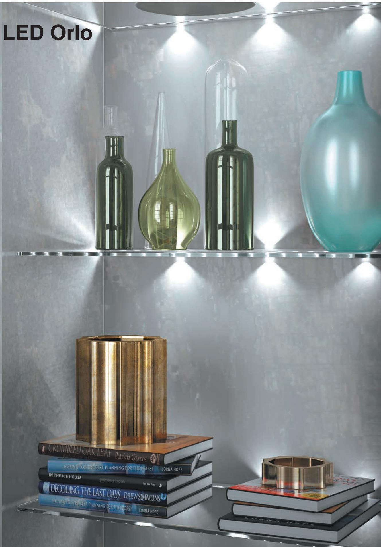
Светильник предназначен для торцевой подсветки полок и фоновой подсветки задней стенки. Устанавливаются на стеклянные полки толщиной 6 или 8 мм. Представлен в трех длинах: 250, 550 и 850 мм. Благодаря специальной конструкции своего пластикового профиля, светильники устанавливаются на заднюю сторону полок.
