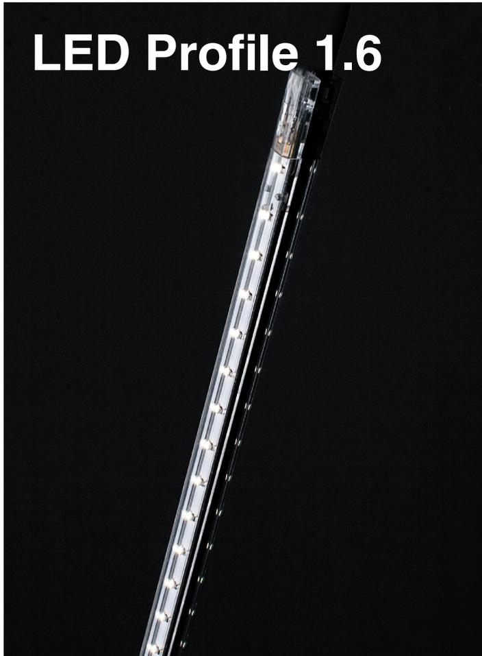
Светильники предназначены для декоративного и функционального освещения мебели и интерьеров. Изготовлены из прозрачного термопластика, который защищает жесткую светодиодную полосу. Светильники имеют длину 300 мм и могут соединяться между собой в непрерывные цепи. При помощи коннекторов возможно создание различных вариантов компоновки. Максимально возможное количество светильников в цепи — 8 штук, что равно длине 2400 мм. Два варианта крепления: при помощи шурупов или на двухсторонний скотч.
