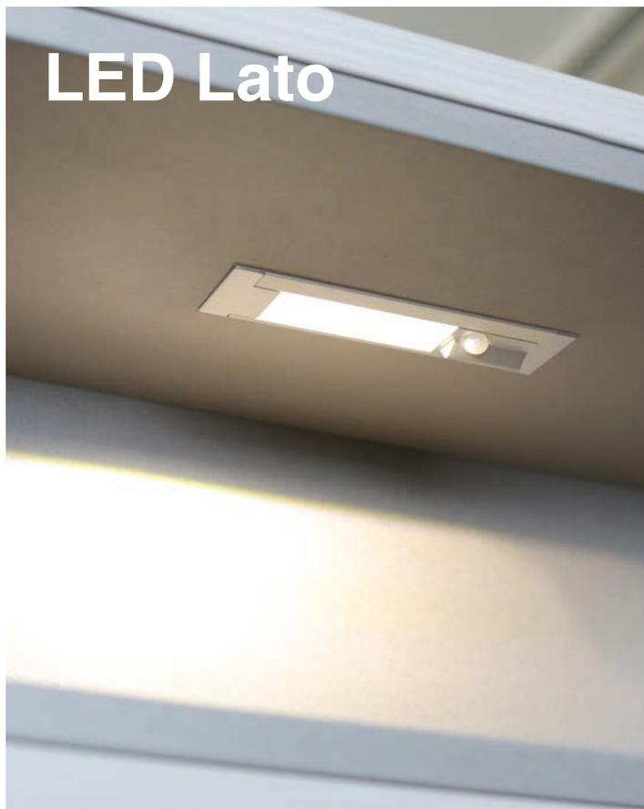
Врезной светильник предназначен для освещения внутреннего пространства мебели. В корпус светильника встроен PIR-датчик движения для автоматического управления светом. В зоне действия датчика свет включается при обнаружении движения и отключается — при его отсутствии. Зона действия датчика: 2000 мм. Время работы после последнего обнаружения движения — 30 секунд. Глубина фрезеровки под установку светильников — 13 мм.
