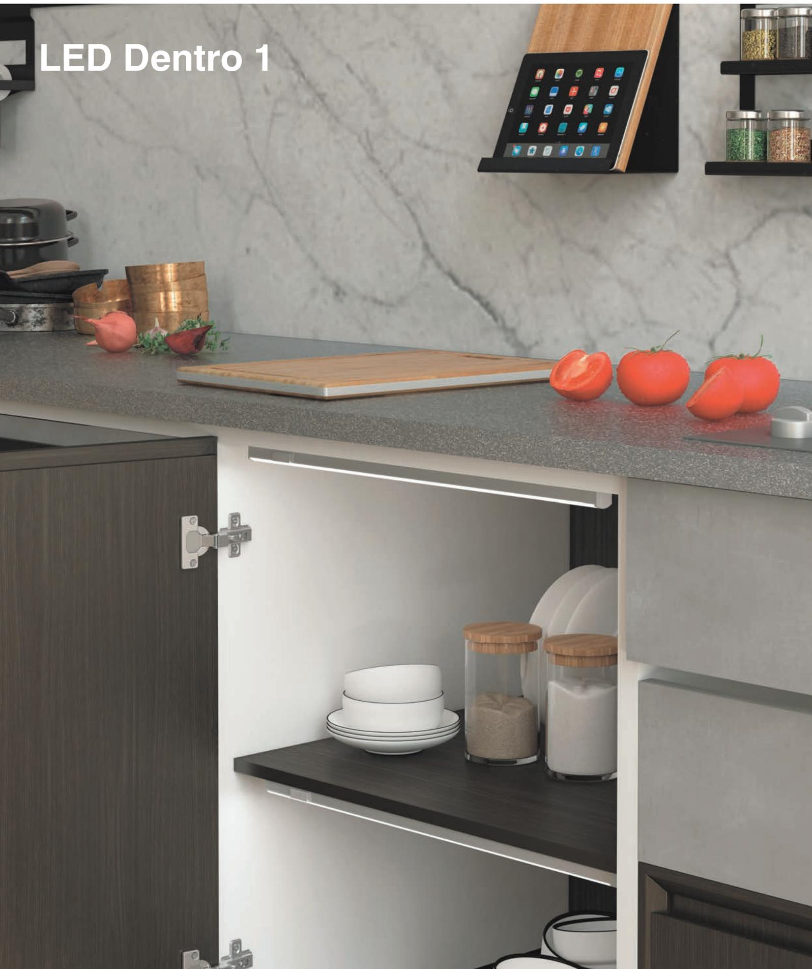
Светильник предназначен для освещения внутреннего пространства кухонных корпусов. В корпус светильника встроен ИР-датчик. Для включения/выключения светильника необходимо просто открыть / закрыть фасад. Зона действия датчика: 2–80 мм. Представлен в трех длинах: для корпусов 450, 600 и 900 мм. Предназначен для корпусов, изготовленных из 16 или 18 мм ДСП.
